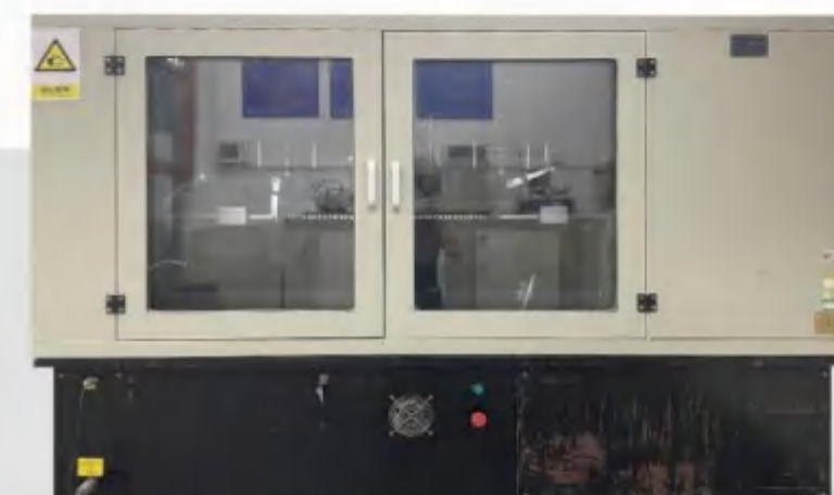
自动车辙试验仪 Automatic rutting tester
