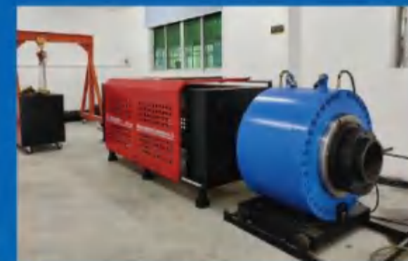
1200吨静载锚固试验机 1200T anchor static load test machine
