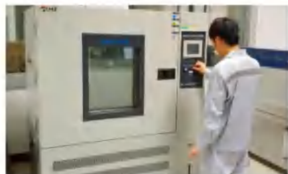
◆ 土工合成材料紫外老化试验 Xenon lamp aging test of geosynthetics
