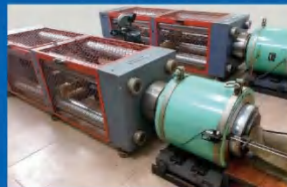
630吨静载锚固试验机 630T anchor static load test machine
