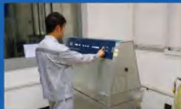
◆ 土工合成材料紫外老化试验 Ultraviolet aging test of geosynthetics
