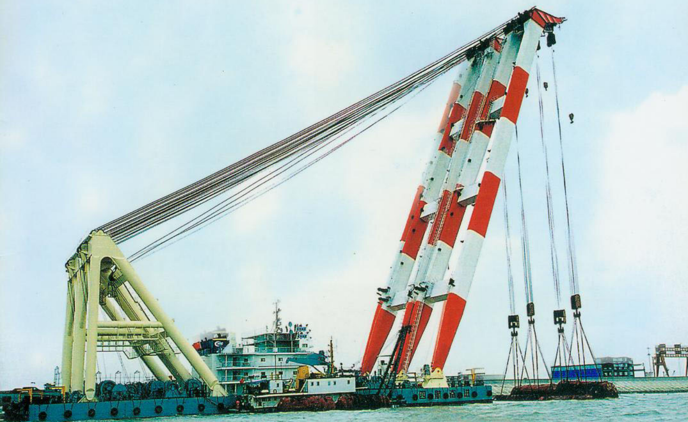
由四航局投资建造的双臂架全液压2600t起重船——‘四航奋进’号
