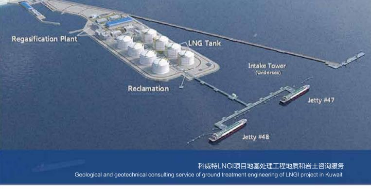
四航研究院承担了项目经理部与疏浚吹填、地基处理相关的地质和岩土专项技术咨询服务,具体为项目疏浚吹填、砂料吹填提供了相关的质量控制方案、吹填区砂料地质分析报告、协助建立了CPT与压实度关系指标并进行优化、协助地基处理施工工艺与检测技术管理,此次咨询的顺利完成确保了吹填砂土质量与地基处理的顺利验收。
