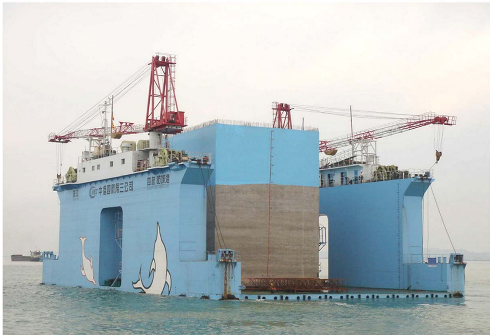
装载防城港电厂码头3000t沉箱的浮船坞——四航局三公司防城港号
