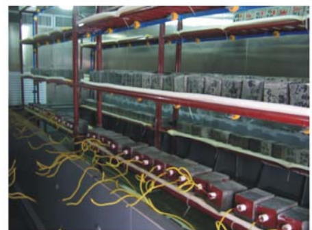
▲ 海水模拟试验箱箱内试件
