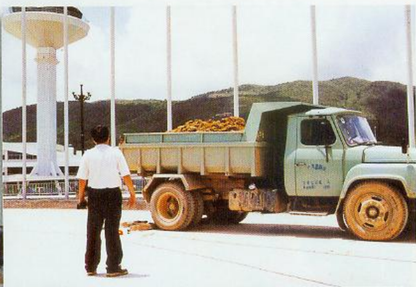
► 桥梁动静载检测—惠州三和北桥动载试验
