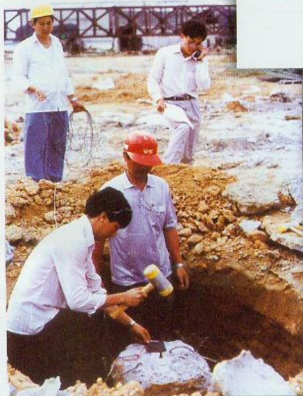
◀ 桩基检测—湛江霞海港 区仓库桩基低应变试验
