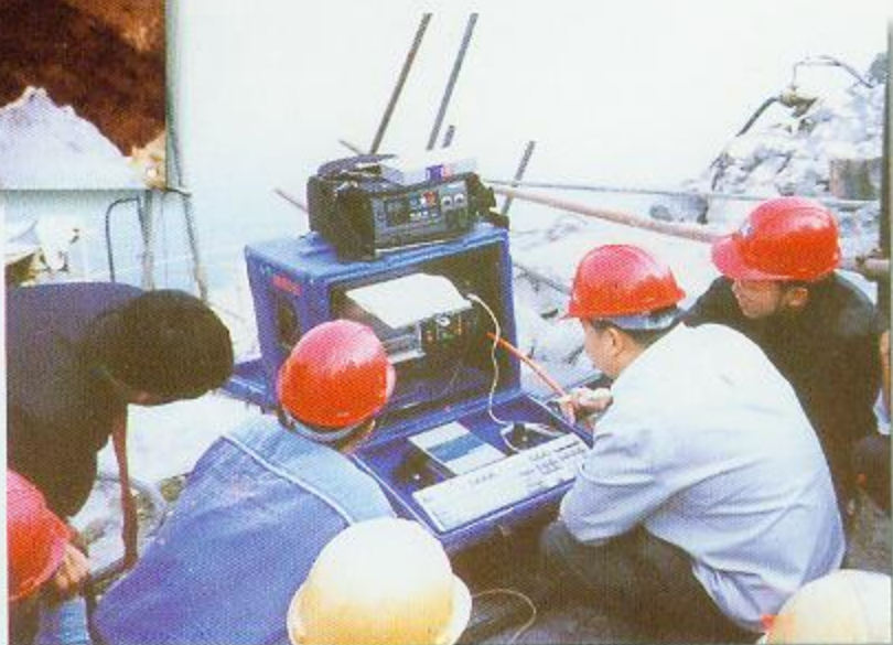
► 水下录相检测—广西来宾电 厂取水口水下录相检查
